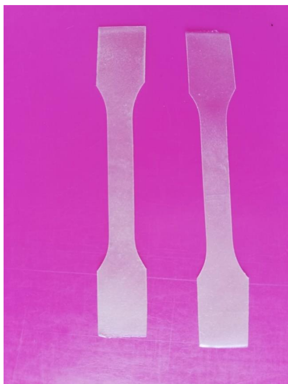
Рис. 3.11. Оптические фотографии исходных пленок ПГБ (а, б), [ПЛА-ПГБ (80:20) мас. % + 10 % ПЭГ 400 (в, г)] до и после экспонирования в почве в течение 180 дней
