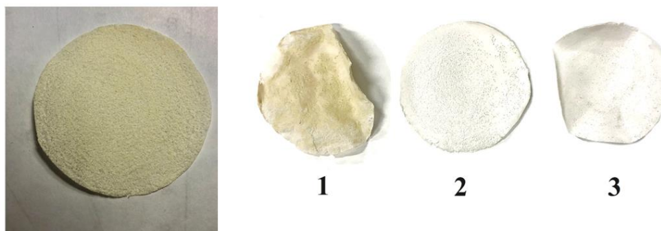
Рис. 5.14. Образцы пленок композиции ПЛА-ПГБ-хитозан (25:25:50) мас. % до и после кислотного гидролиза в растворах HCl различной концентрации: 0,005 (1), 0,1 (2), 0,2 (3) моль/л
