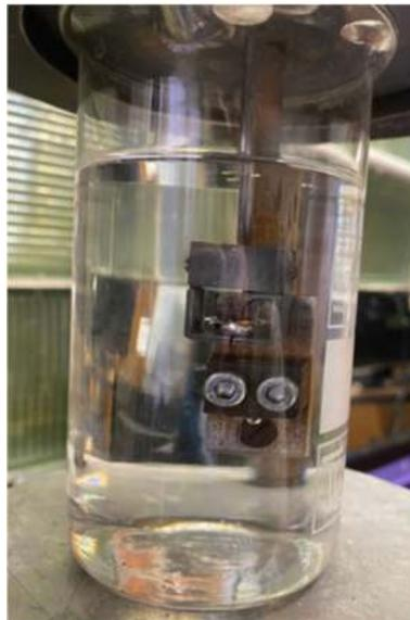
Рис. 2. Образец в зажимах одногнездового адгезиометра при нагружении в жидкости
